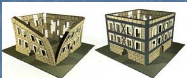
cerchiatura esterna con nastri monodirezionali in carbonio
