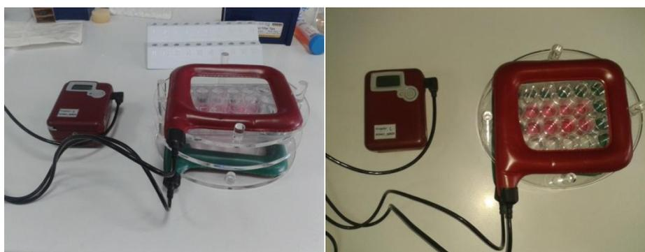
**Figura 1.** PEMF Power Supply e sistema di esposizione.
