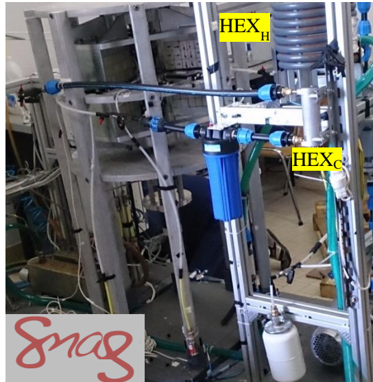
Figura 41 - Particolare del prototipo 8Mag con evidenza degli scambiatori di calore lato caldo e lato freddo
