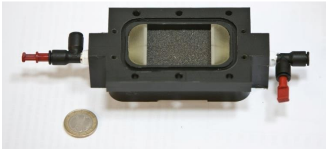
Figura 42 - Dettagli di un rigeneratore: 1) Guscio, 2) Diffusori, 3) MCM, 4) Attacco rapido filettato
