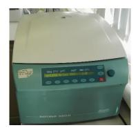
Figure 6.7 Centrifuge (Rotina 380r-Hettich Zentrifugen)
