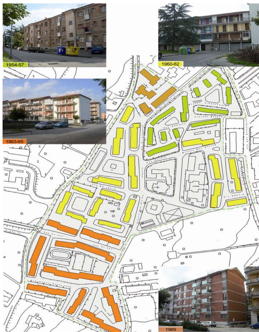
Fig. 28. Ricostruzione delle fasi di costruzione del Rione S. Tommaso nella parte meridionale della città di Avellino.
