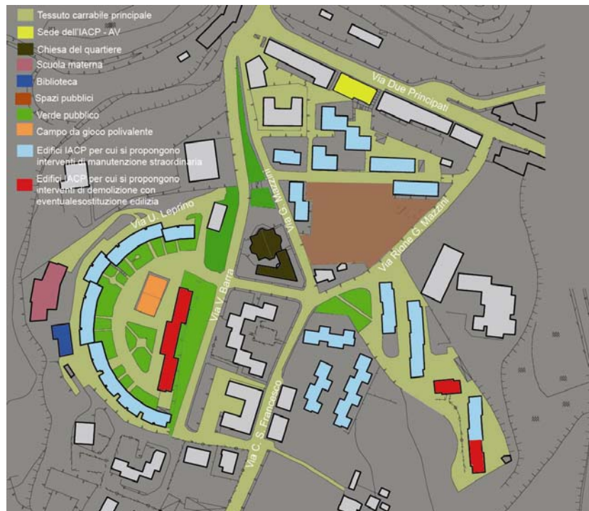
Fig. 30. Sintesi interpretativa delle condizioni attuali del quartiere rione Mazzini Ovest nella città di Avellino.
