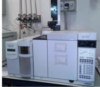
Figura 3.21 - GC-FID dotato di autocampionatore.
