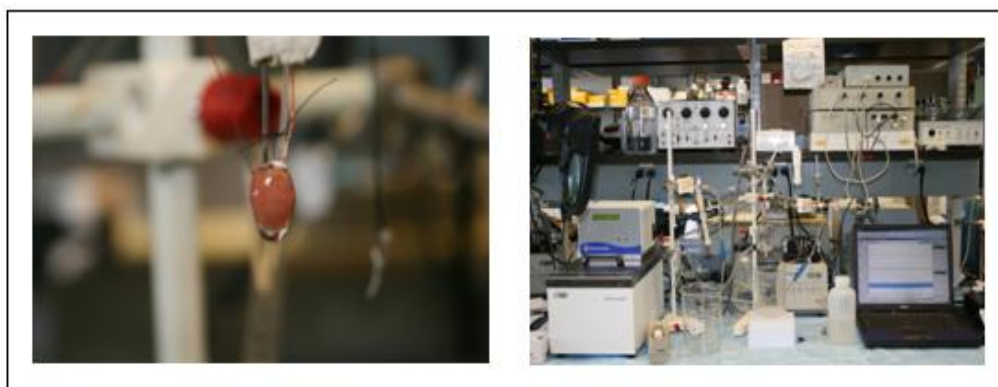
Fig. 3 rappresentazione del sistema di Langendorff. Sul lato sinistro, il cuore isolato con il palloncino inserito nel ventricolo sinistro. Sul lato destro l'apparato di Riperfusione completo.
