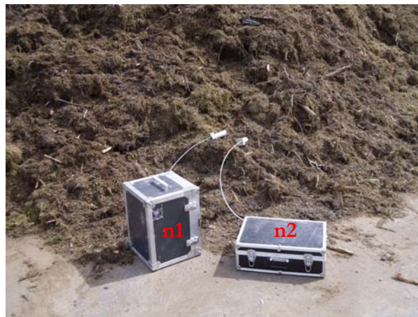
Figura 5.41 2 nasi elettronici utilizzati in campo ai fini della comparazione dei dati di misura
