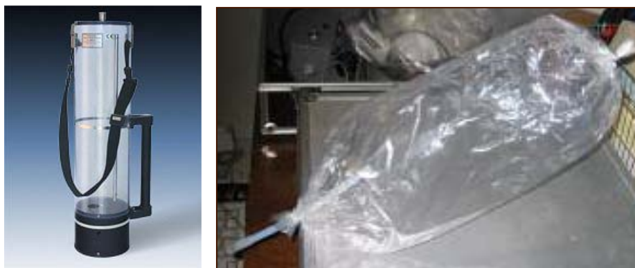
Figura 5.49 Campionatore statico (sx); sacchetto Nalophan® (dx)
