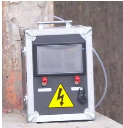
Figura 5.11 Naso elettronico utilizzato in campo
