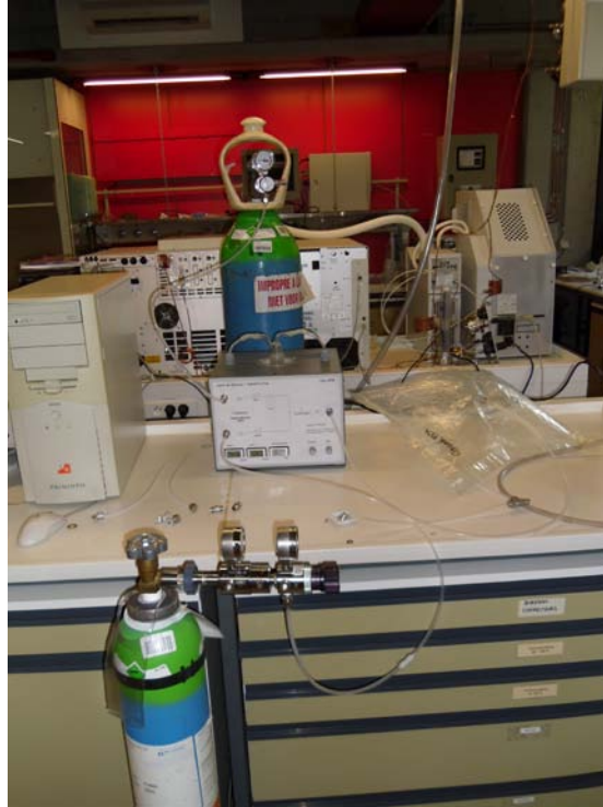
Figura 5.15 Preparazione della miscela standard di etanolo in laboratorio da sottoporre al naso elettronico
