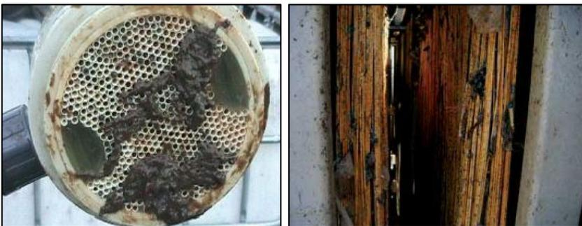
Figura 3.1 Fouling delle membrane.
