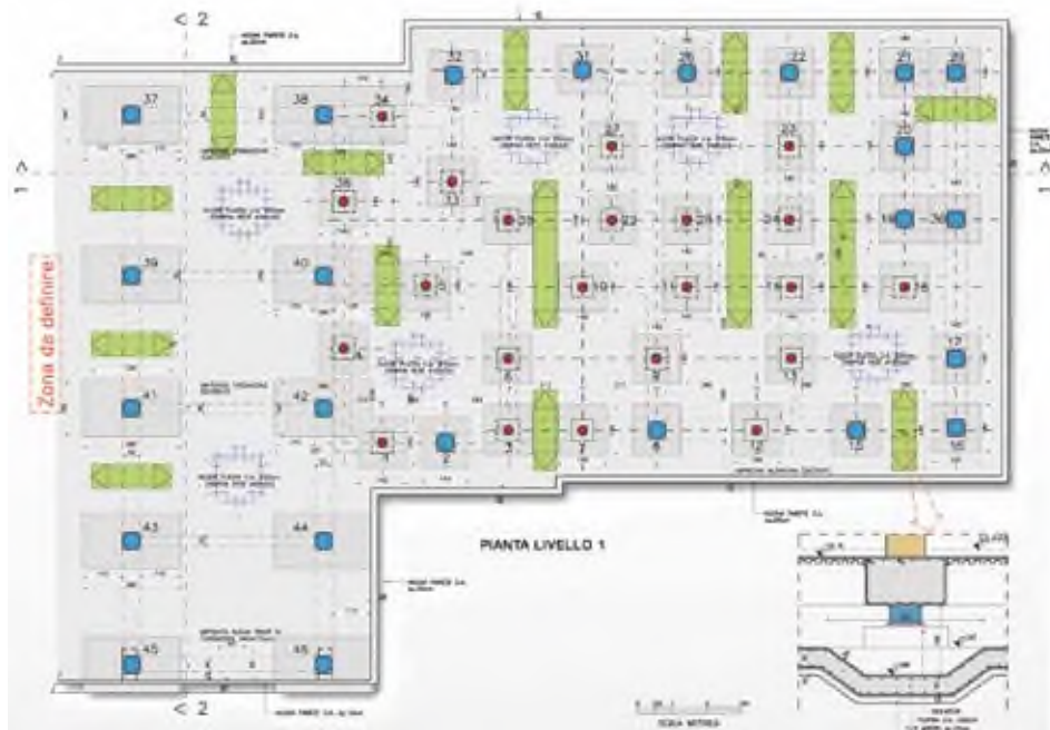
Fig. 3.7.6: Disposizione in pianta degli isolatori
