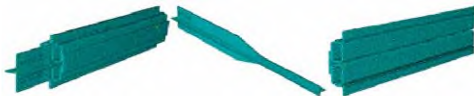
Fig. 3.3.7: Modellazione FEM degli elementi dei controventi BRB
