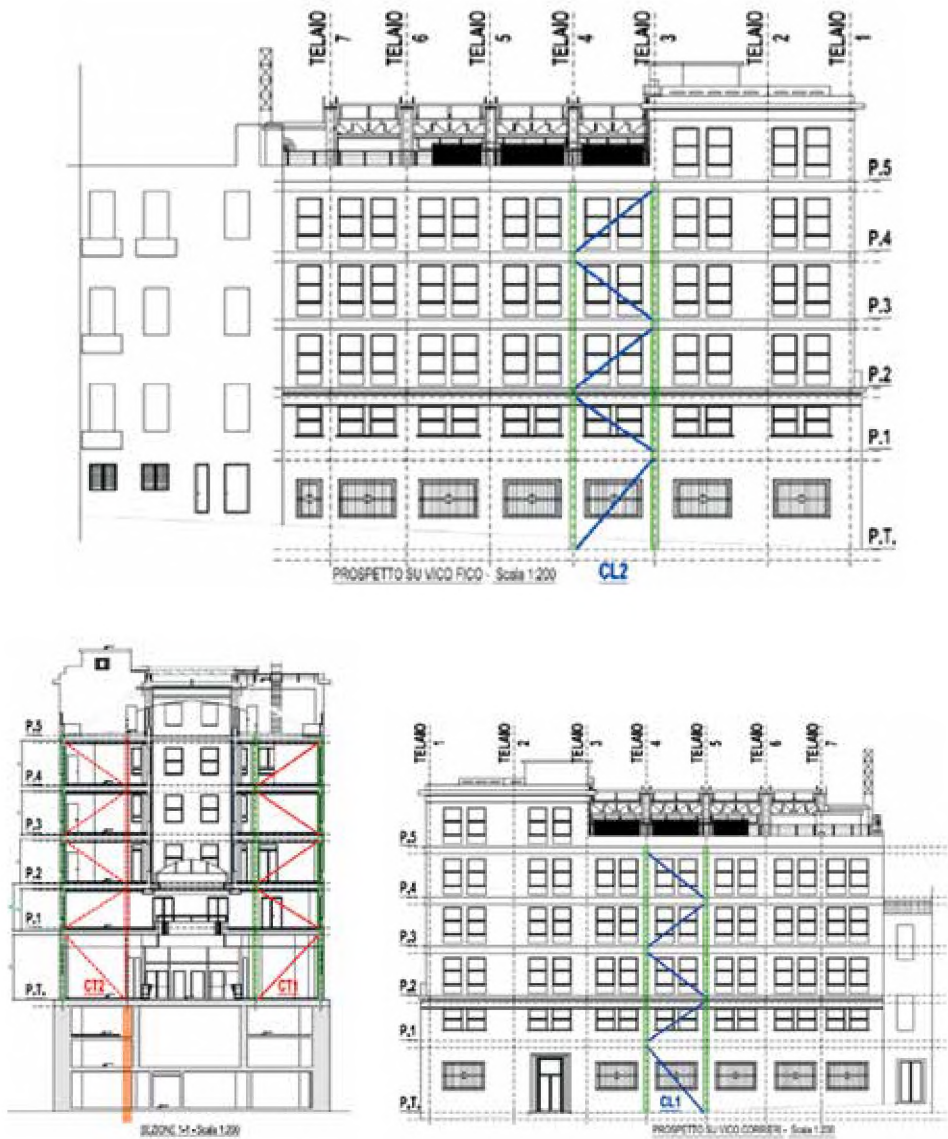
Fig. 3.3.5: Disposizione in elevazione dei controventi BRB
