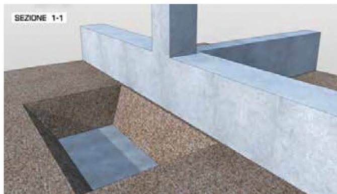
Scavo ed esecuzione 1° plinto di fondazione 160x80xH60
