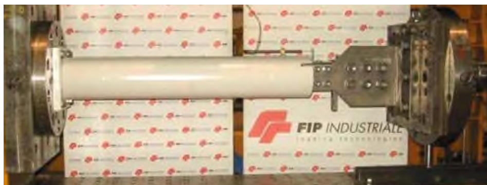
Fig. 1.2.7: Dispositivo BRB (immagine riprodotta con permesso della FIP industriale SpA - https://www.fipindustriale.it/ , accesso effettuato in data 31.05.2019)
