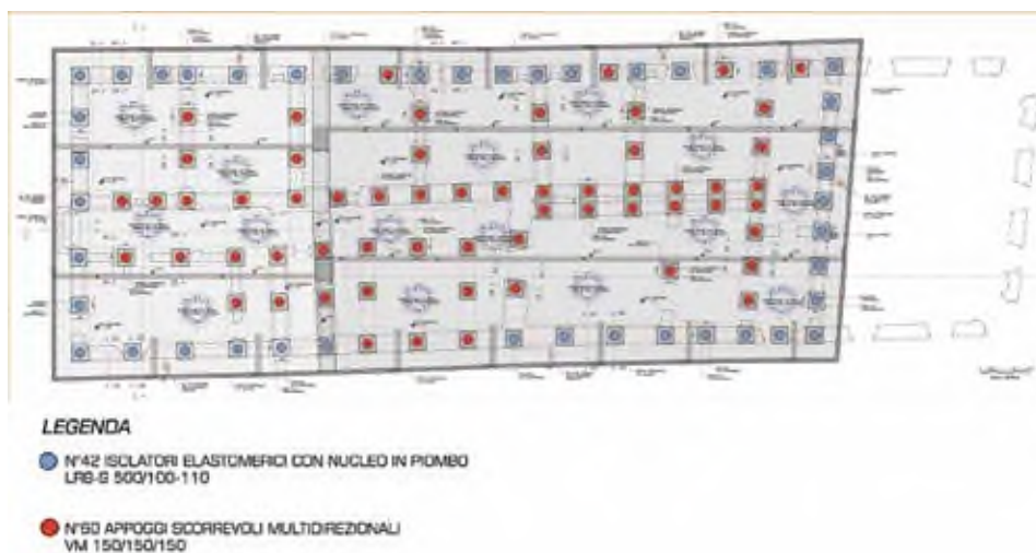
Fig. 3.5.4: Disposizione degli isolatori in fondazione
