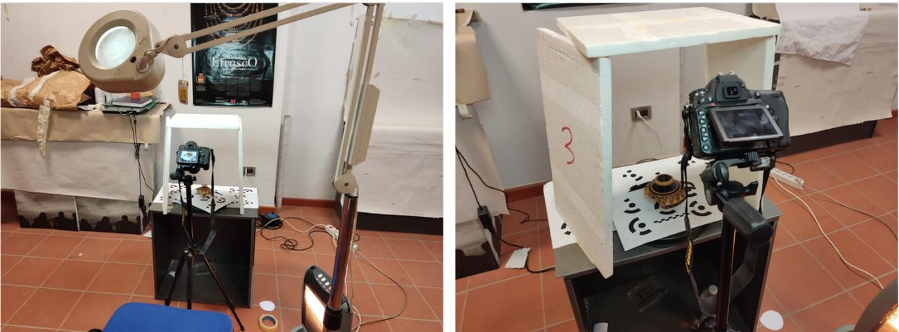
Fig. V.91 - Il rilievo fotogrammetrico con l'impostazione di diverse fonti di illuminazione e dei *marker*
