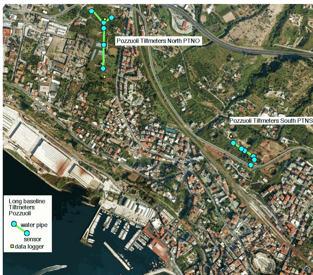
Figura 4.16: Illustrazione in scala della rete di inclinometri installata a Pozzuoli
