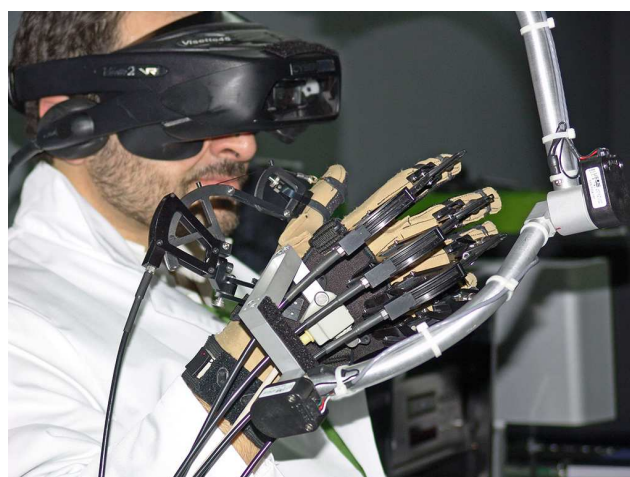
Fig. 5.11a 5.11b Interazione aptica nell'applicazione di manutenzione proposta usando il sistema a ritorno di forze CyberForce
