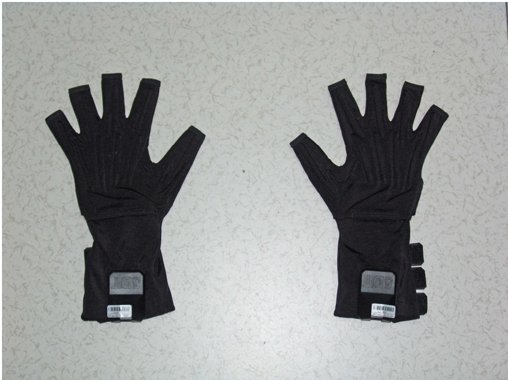
Fig. 1.3 Guanti sensoriali o Cyber Glove
