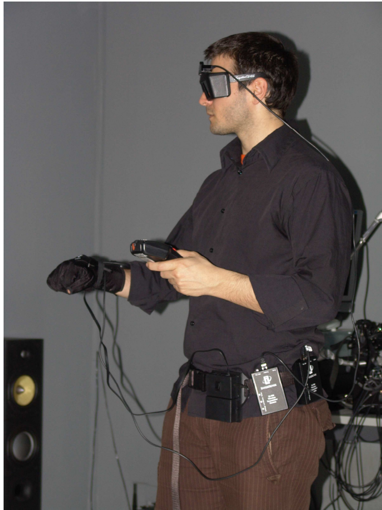
Fig 1.10a Joystick, sensori e dispositivi di ricezione di InterSense IS-900 1.10b Utente di InterSense IS-900 Precision Motion Tracker
