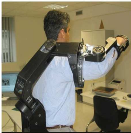
Fig. 2.16 Light Arm Exoskeleton (PERCRO Scuola Sant'Anna di Pisa)
