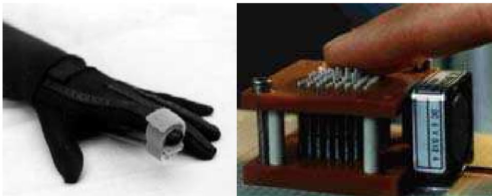
Fig. 2.17 Dispositivi tattili (Termico a sinistra, Vibrotattile a destra)
