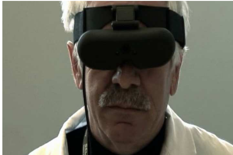
Fig. 1.8 Utente di un'applicazione di A.R. che indossa un dispositivo di tipo Video See Through
