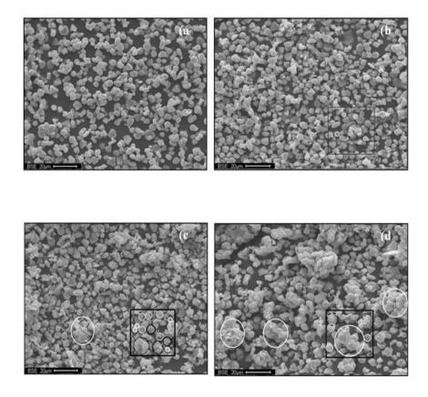
**Figure 93** SEM imagines of a) ZSP; b) 15 N-TiO<sub>2</sub>/ZSP; c) 30 N-TiO<sub>2</sub>/ZSP; d) 50 N-TiO<sub>2</sub>/ZSP
