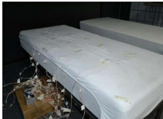
**Figura IV. 2** *Posizionamento delle RTD sul materasso e sul soggetto.*
