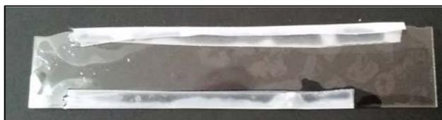
Figura 1. In figura è mostrato il supporto di silicio utilizzato per l'immobilizzazione della pOBP.
