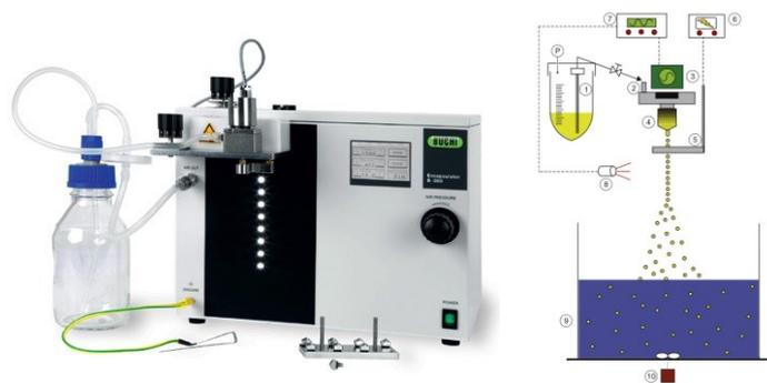
**Figure 10. Büchi encapsulator B-390 apparatus**
