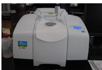
**Figure 16. FTIR spectrophotometer apparatus.**
