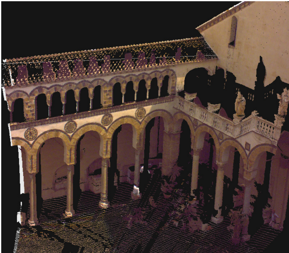
Rilievo del quadriportico del duomo di Salerno con il laser scanner Iris 3 6 D
