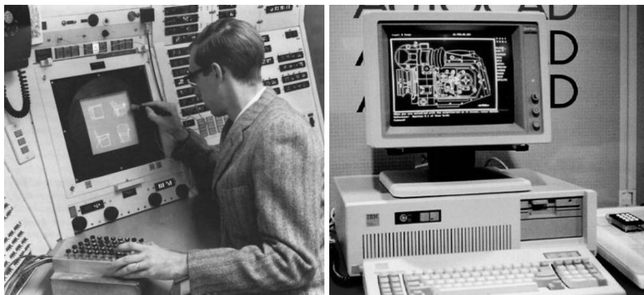
Fig. 17 A sinistra lo Sketchpad, a destra il 'tecnigrafo elettronico'
