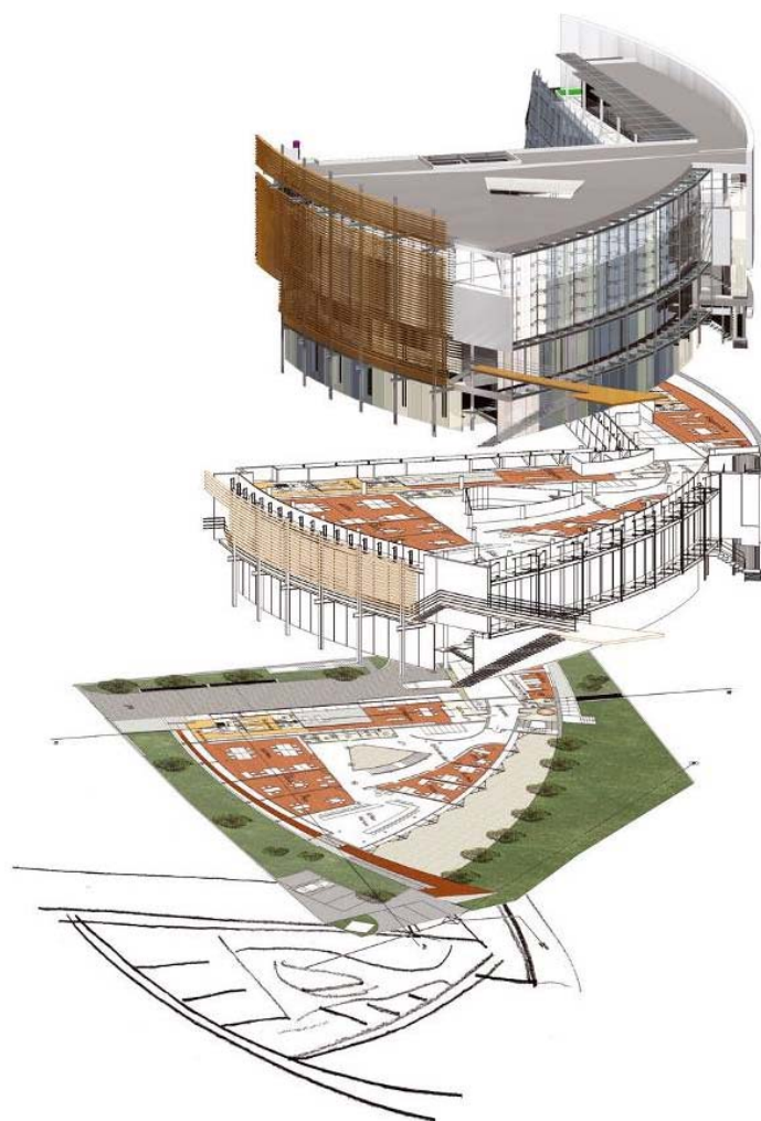
Fig. 20 Dallo schizzo a mano (in basso) al modello bim (in alto), passando per il disegno al CAD e la modellazione 3D
