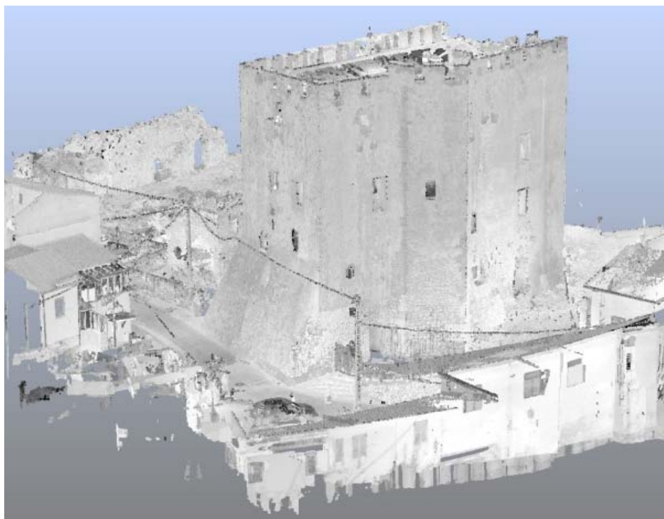
Fig. 84 Modello completo a nuvola di punti del Castello in ambiente Faro Scene 5.1
