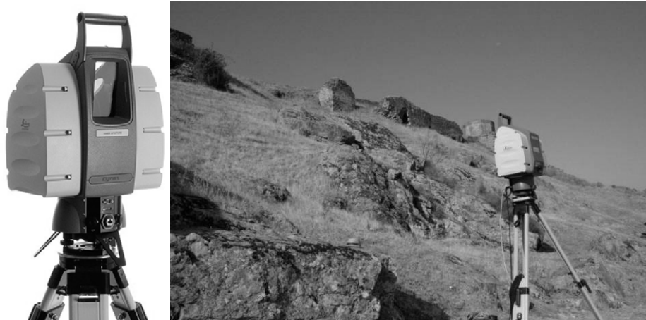
Fig. 33 Un laser-scanner a tempo di volo per il rilievo di grandi dimensioni
