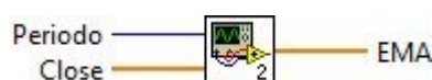
Figura 4.21. Input/Output del vi per il computo della media mobile semplice ed esponenziale.
