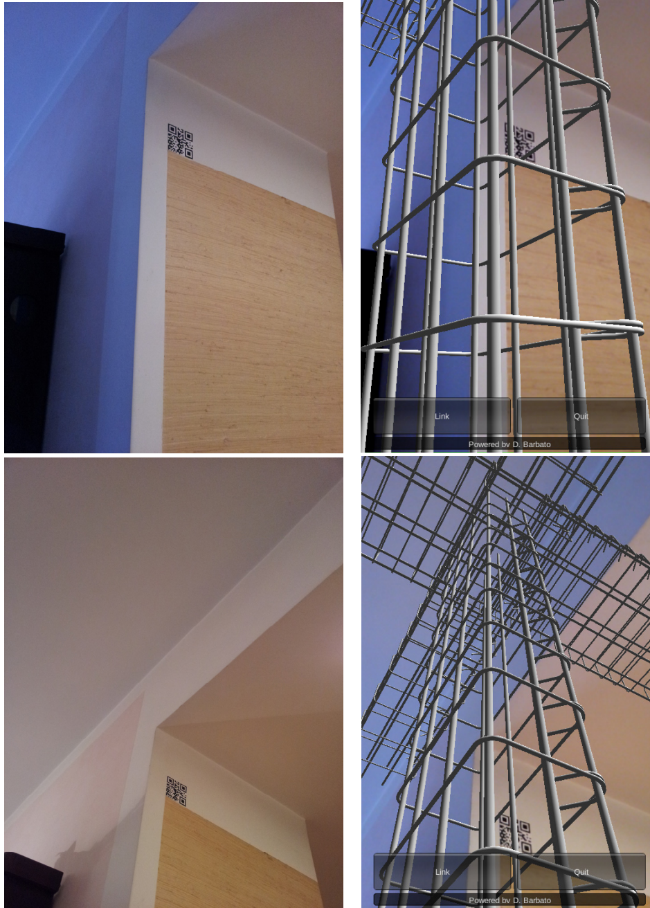
Fig. 86 Visualizzazione in sito di un nodo strutturale
