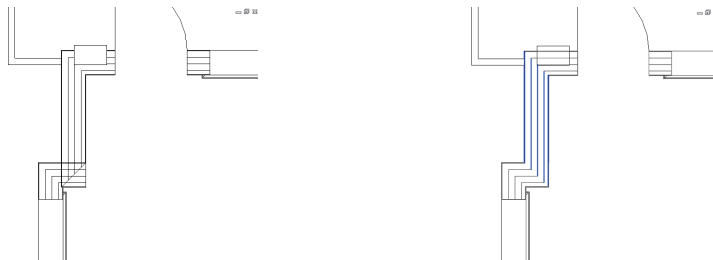
Fig. 31 Cattiva intersezione dei rompagni e risoluzione della connessione
