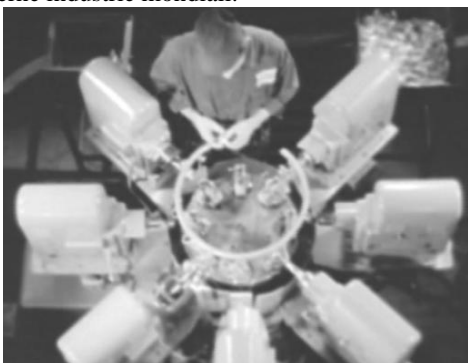
Una macchina perforatrice multipla al lavoro
