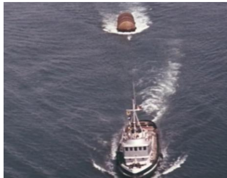
Il trasporto via mare di un generatore di vapore
