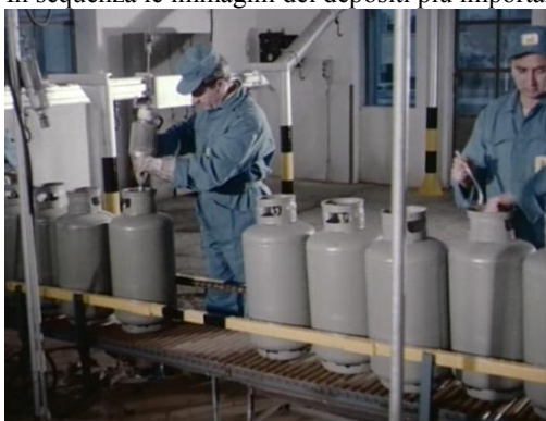
Stazione di imbottigliamento di gas liquido in bombole
