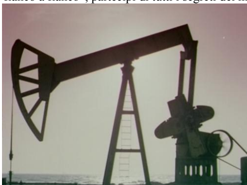
Una pompa a cavalletto (“un dinosauro d’acciaio”)
