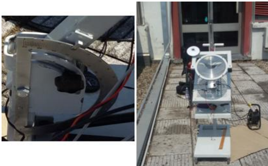
Figura V.9 Goniometro per l'inclinazione Nord – Sud e sistema inclinato
