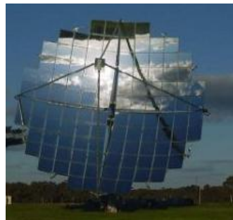
Figura I.18 Esempio di sistema dense array
