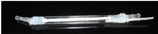
Figura 5.1 Membrana in polisulfone alloggiata in tubo di vetro
