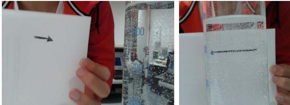
figura 1 a) Freccia disegnata su un foglio b) la stessa freccia appare invertita se vista attraverso un contenitore cilindrico pieno d'acqua
