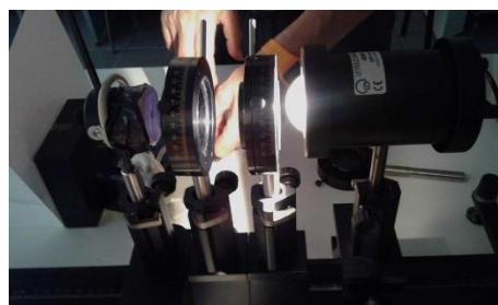
Fig 2 a) schema dell'apparato sperimentale b) foto del banco sperimentale per la verifica della legge di Malus.
