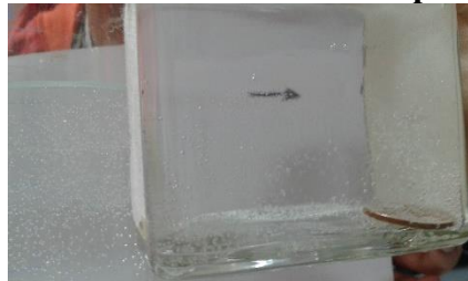
figura 1 a) Freccia disegnata su un foglio b) la stessa freccia appare invertita se vista attraverso un contenitore cilindrico pieno d'acqua
