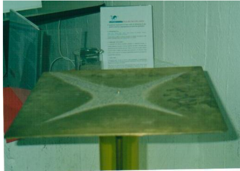
Figura 4 Figure di Chladi su piastra di rame vibrante
