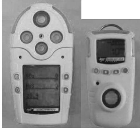
**Figure VI.15:** *Gas Alert Micro: a) Multigas, b) monogas*
