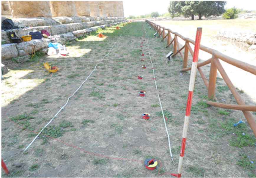
Figura 5.3.3: Stendimento multielettrodo n.3 effettuato presso il Tempio di Nettuno nel Parco Archeologico di Paestum. Tomografia geoelettrica E-F. 64 elettrodi di misura, spaziatura elettrodica 1m. Lunghezza complessiva stendimento 63m.
