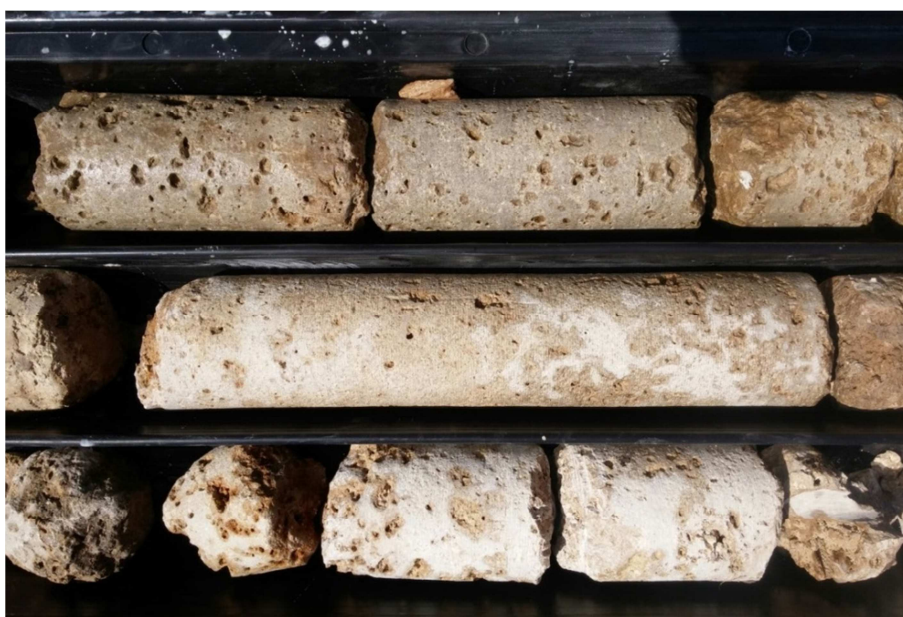
Figura 5.3.2.4: Particolare del livello di travertino che risulta molto compatto e con presenza di vacuoli (vuoti).
