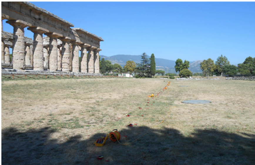
Figura 5.3.6: Stendimento multielettrodo n.6 effettuato presso il Tempio di Nettuno nel Parco Archeologico di Paestum. Tomografia geoelettrica M-N. 48 elettrodi di misura, spaziatura elettrodoica 1.3m. Lunghezza complessiva stendimento 61.1m.
