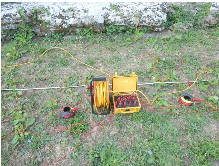
Figura 5.3.1.2: Box MAE con 8 canali per misure multielettrodo collegato tramite connettori agli elettrodi e, in cascata, agli altri box e al georesistivimetro.
