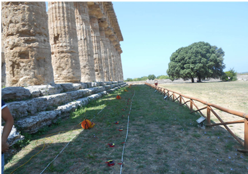
Figura 5.3.2: Stendimento multielettrodo n.2 effettuato presso il Tempio di Nettuno nel Parco Archeologico di Paestum. Tomografia geoelettrica C-D. 64 elettrodi di misura, spaziatura elettrodo 1m. Lunghezza complessiva stendimento 63m.
