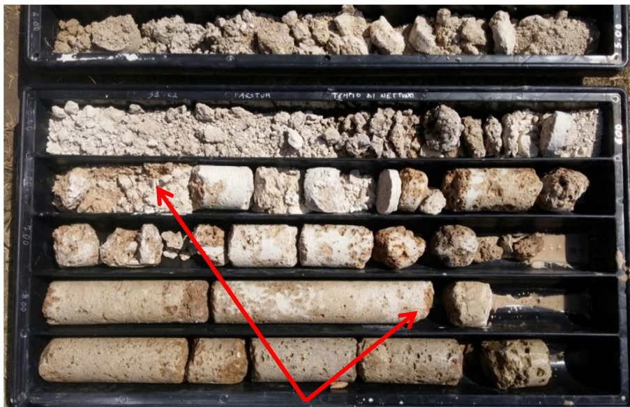
Figura 5.3.2.3: Cassetta catalogatrice C2 del sondaggio realizzato (profondità 5-10m dal p.c.). Si evidenzia la presenza di travertino compatto a partire dalla profondità di circa 6m dal p.c., in buon accordo con le indagini eseguite.
