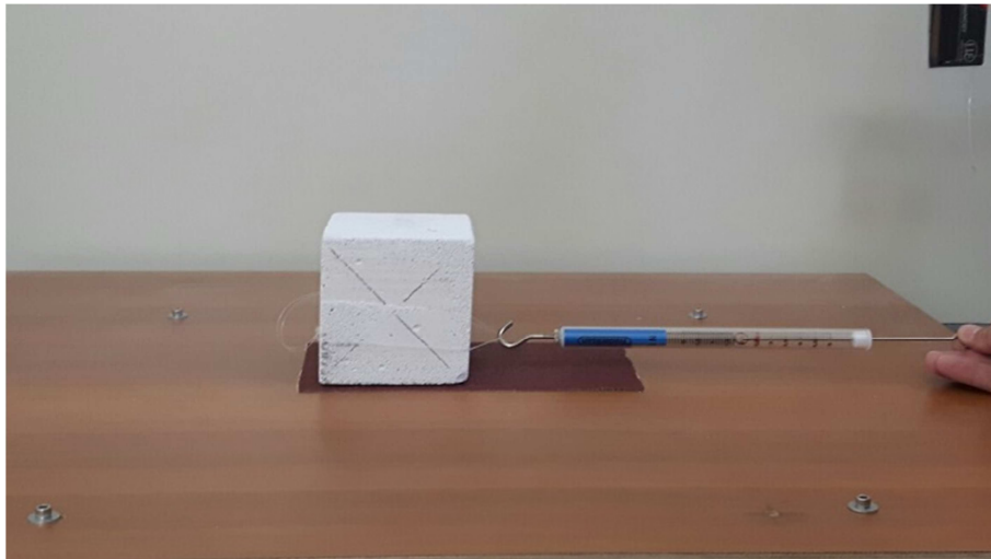
Figura 4.1.1: Configurazione di prova carta vetrata - cemento cellulare.
