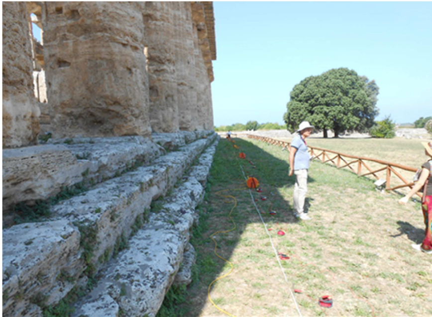
Figura 5.3.1: Stendimento multielettrodo n.1 effettuato presso il Tempio di Nettuno nel Parco Archeologico di Paestum. Tomografia geoelettrica A-B. 64 elettrodi di misura, spaziatura elettrodo 1m. Lunghezza complessiva stendimento 63m.
