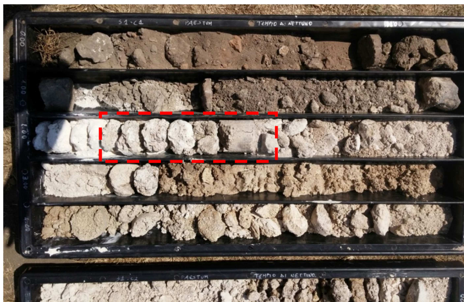
Figura 5.3.2.2: Cassetta catalogatrice C1 del sondaggio realizzato (profondità 0-5m dal p.c.). Si evidenzia la presenza di un blocco di travertino a profondità comprese tra 2.0 e 2.4m dal p.c..
