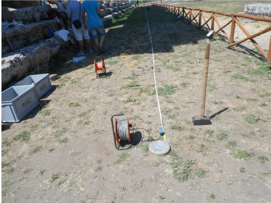
Figura 5.4.1.1: Sorgente energizzante, costituita da massa battente di 8kg su piastra di alluminio. Come starter/trigger è stato utilizzato un geofono verticale Geospace a 14Hz.
