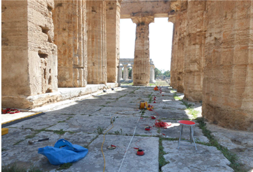
Figura 5.3.5: Stendimento multielettrodo n.5 effettuato presso il Tempio di Nettuno nel Parco Archeologico di Paestum. Tomografia geoelettrica I-L. 32 elettrodi di misura, spaziatura elettrodoica 1.1m. Lunghezza complessiva stendimento 34.1m.
