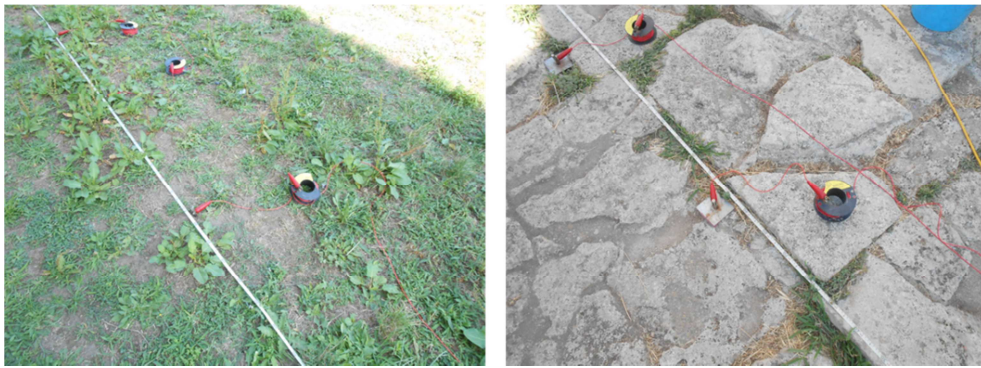
Figura 5.3.8: Picchetto in acciaio inox conficcato nel terreno in alto ed elettrodo speciale costituito da piastra d'acciaio inox poggiata sulla pavimentazione. In questo secondo caso il contatto elettrico è assicurato dall'uso di soluzioni saline o semplicemente acqua attorno agli elettrodi.
