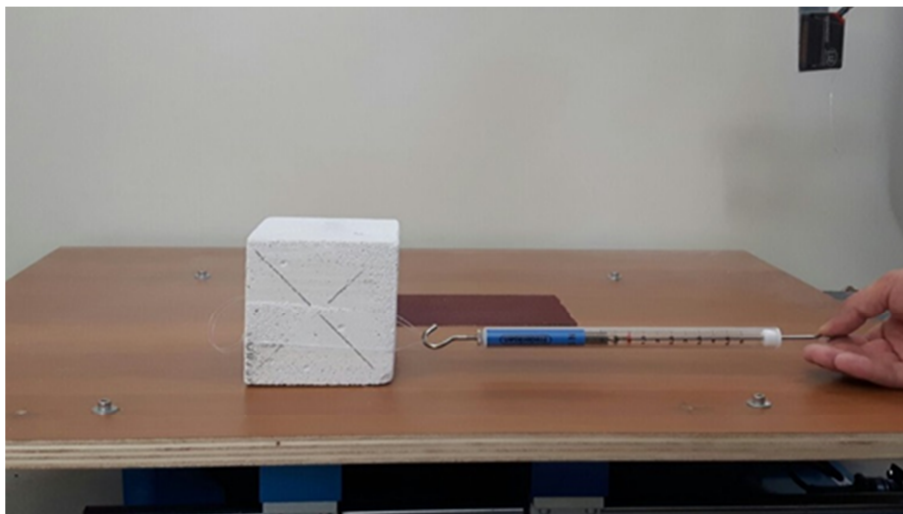
Figura 4.1.11: Configurazione di prova legno – cemento cellulare.
