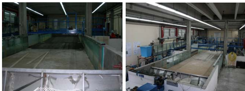
Figura 4.5 Vasca con ondogeno in dotazione al Laboratorio di Idraulica del Dipartimento di Ingegneria Civile e Ambientale dell'Università di Catania
