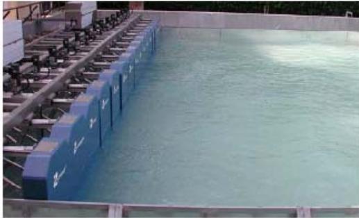
Figura 2.11 Ondogeno con sistema "Piston Paddle Motion"
