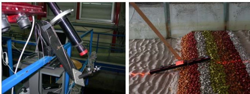
Figura 4.13 Immagine del laser adottato ed esempio di foto utilizzata per la calibrazione
