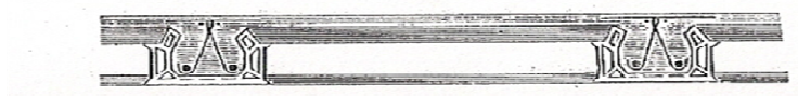
fig. 68: solaio tipo Villa con imposte armate (da Baluffi G., Costruzioni in cemento armato , Ulrico Hoepli Editore - Libraio della Real Casa, Milano 1922).
