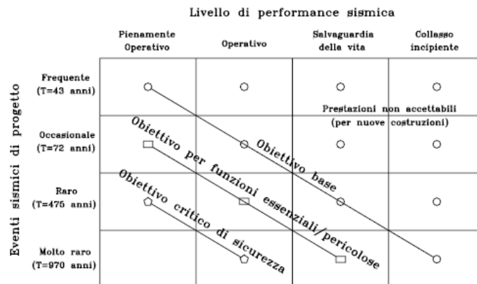
Figura 5.2.1 Matrice degli obiettivi sismici prestazionali di progetto (PDOM)
