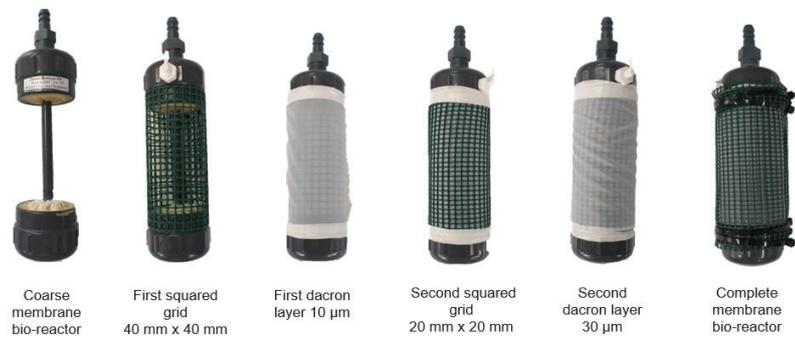
**Figura 6-20** Layer della membrana dinamica autoformante
