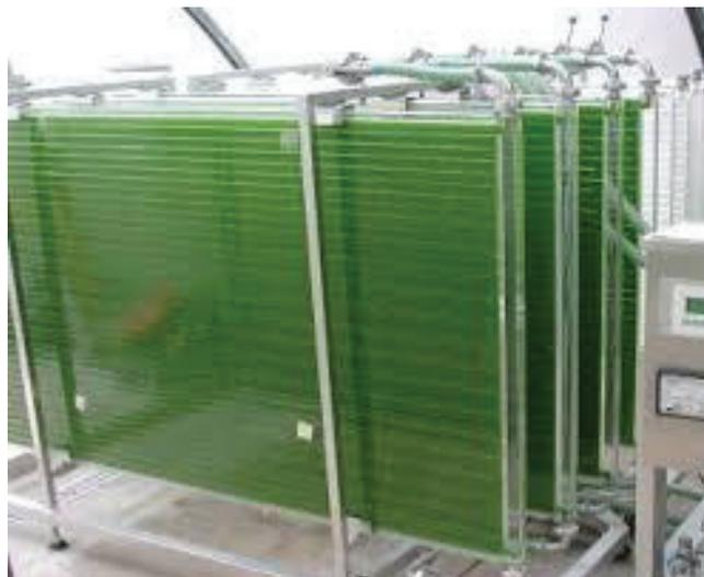
Figura 4-4 Sistema a pannelli costituito da lastre trasparenti in configurazione verticale (Fonte: [webapi.ingenio-web.it](http://webapi.ingenio-web.it))
