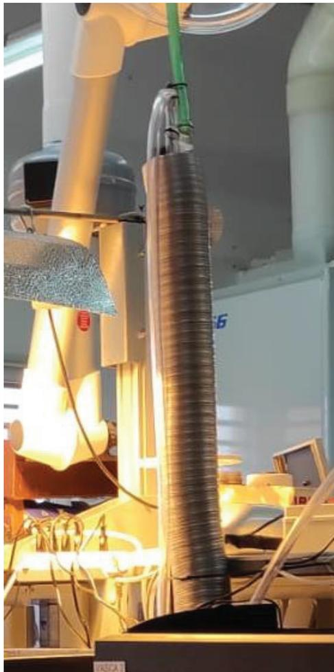
Figura 6-23 Cilindro metallico con alloggio luce UV
