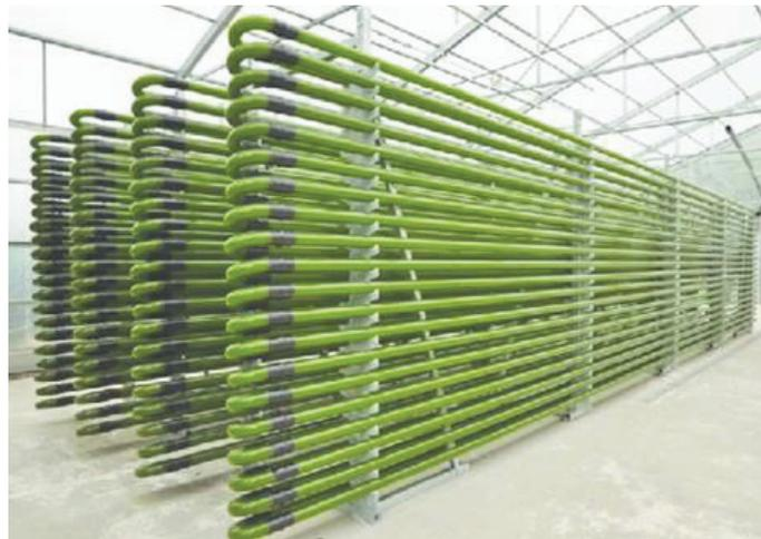
Figura 4-3 Sistema a tubolari orizzontali in serie e parallelo con diametro di 15 cm (Fonte: [terraevita.edagricole.it](http://terraevita.edagricole.it))
