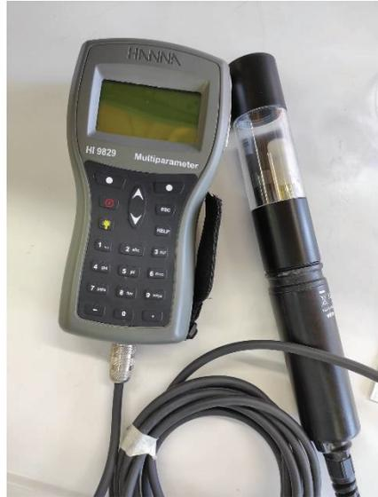
Figura 6-27 Sonda multiparametrica
