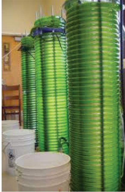
Figura 4-5 Sistema elicoidale con tubi in polietilene a raggio costante e sistema di illuminazione interno (Fonte: [biorefining.cfans.umn.edu](http://biorefining.cfans.umn.edu))
