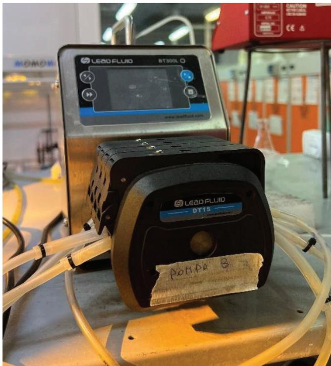
**Figura 6-13 Pompa peristaltico Lead Fluid BT300L**
