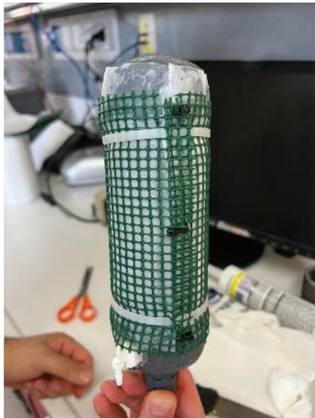
**Figura 6-21** Membrana dinamica autoformante assemblata in laboratorio
