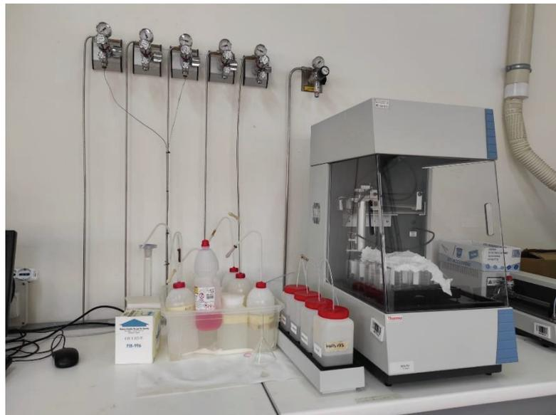
Figura 6-30 Analizzatore di carbonio
