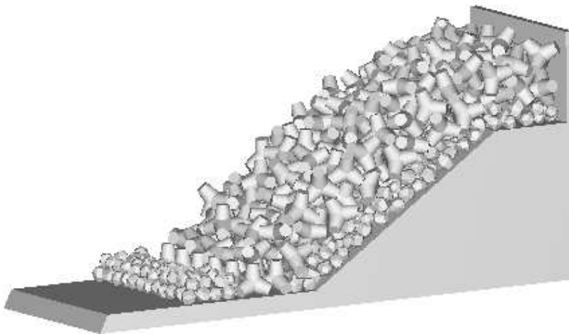
Figura 3.10 Struttura 3D con mantellata in Tetrapodi con strato filtro e protezione al piede - pendenza 2/3
