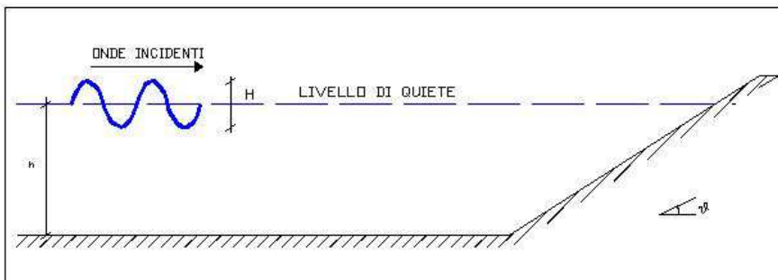
Figura 4.4 Schema adottato per lo studio della riflessione su parete impermeabile inclinata
