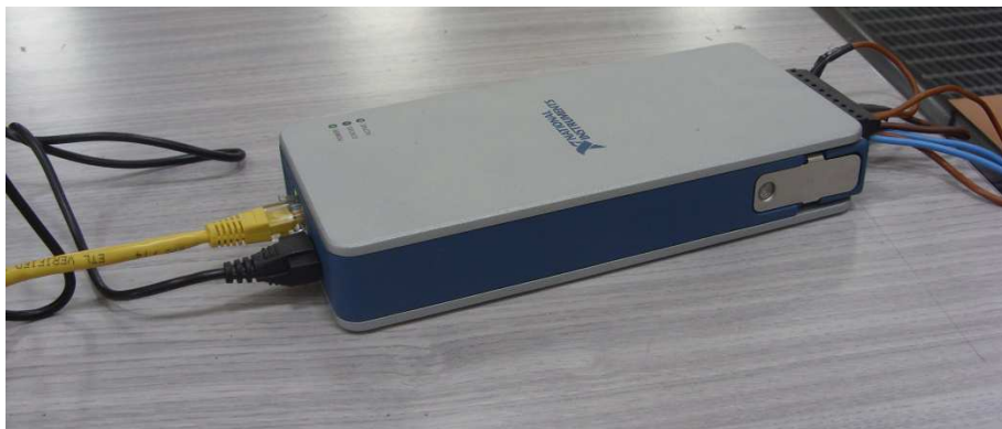
Figura 3.12 Scheda di acquisizione.
