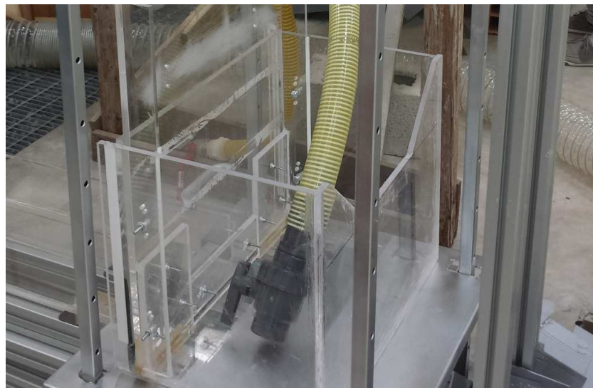
Figura 3.18 Foto della vasca con dettaglio dello stramazzo Cipolletti.
