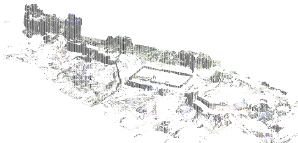
Fig. 38 Il modello completo a nuvola di punti di un castello
