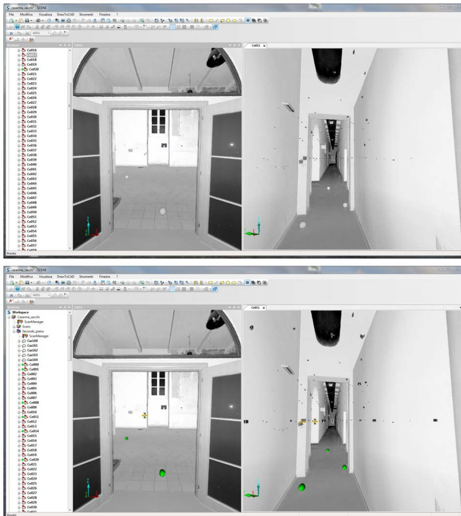
Fig. 57 Visualizzazione rapida di una scansione prima (in alto) e dopo (in basso) aver lanciato il comando di riconoscimento automatico dei target sferici e piani
