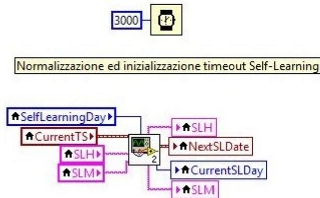
Figura 174 - Codice per la normalizzazione e l'inizializzazione del time-out per la fase di auto apprendimento.
