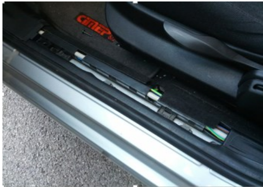
Figura 40- Cavi elettrici sotto le piastre di copertura
