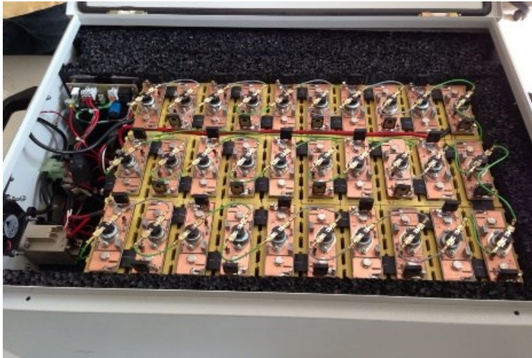
Figura 29-Pacco batteria agli ioni di Litio utilizzata per il kit
