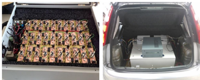
Figura 38-Pacco batteria, box contenete scheda NI 6212 e driver installati nel cofano della FIAT Grande Punto
