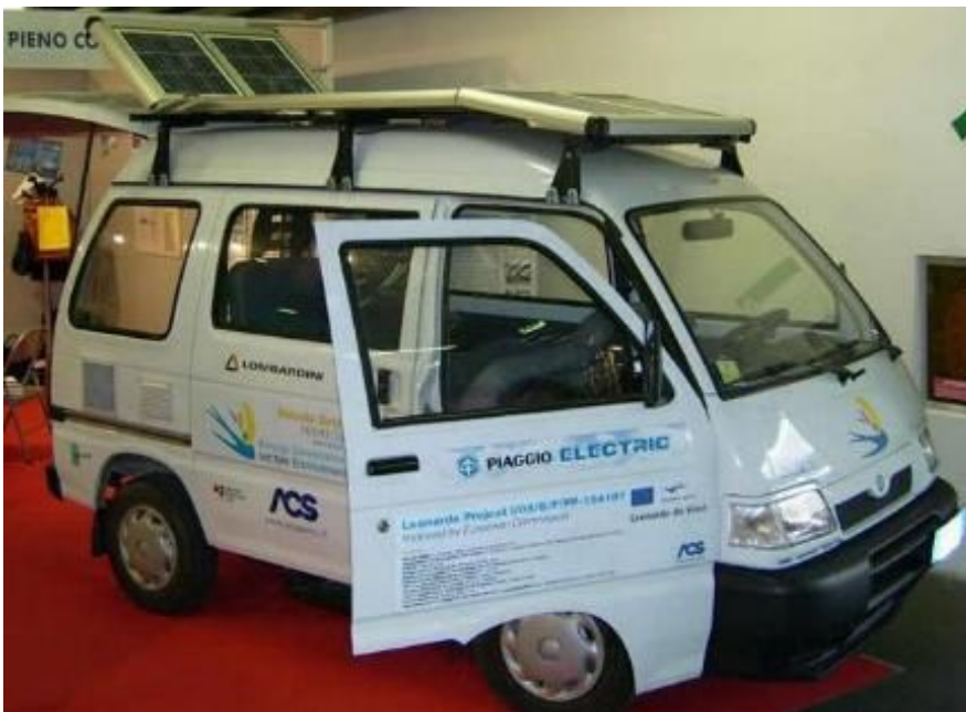
Figura 9 Piaggio porter ibrido, prototipo Università degli studi di Salerno.
