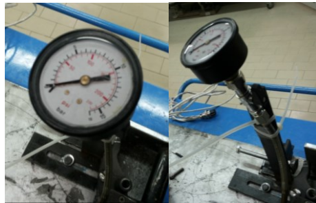
Figura 52 - Manometro e relativo posizionamento
