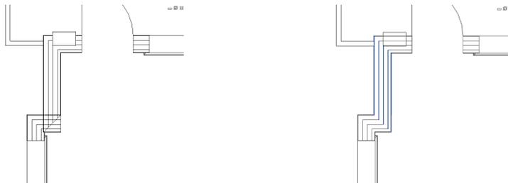
Fig. 31 Cattiva intersezione dei tomagni e risoluzione della connessione
