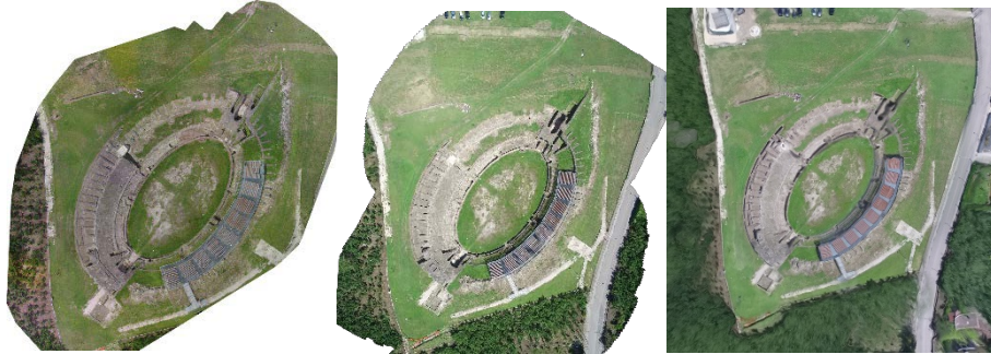
Figura 80: Ortofoto restituida con medio 'ligero':fotogrametrico, vídeo en nadir y vídeo 360° (dx).
