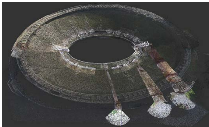
Figura 51: Integración de los datos TLS (galería) con datos de VANT (externo).
