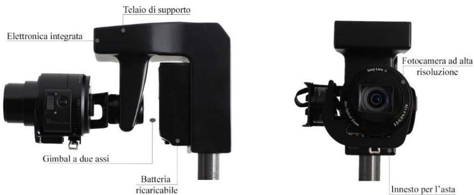
Figura 81: Cámara fotográfica estabilizada a través del gimbal con dos ejes.
