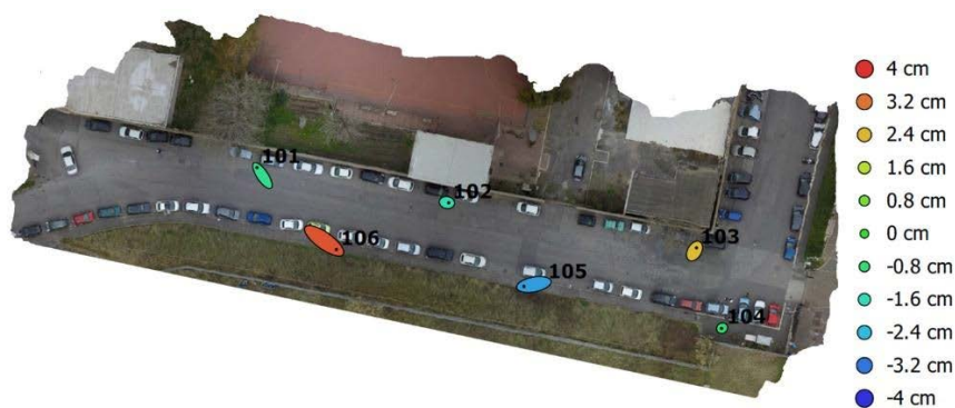
Figura 88: Distribución de los GCP en la carretera.
