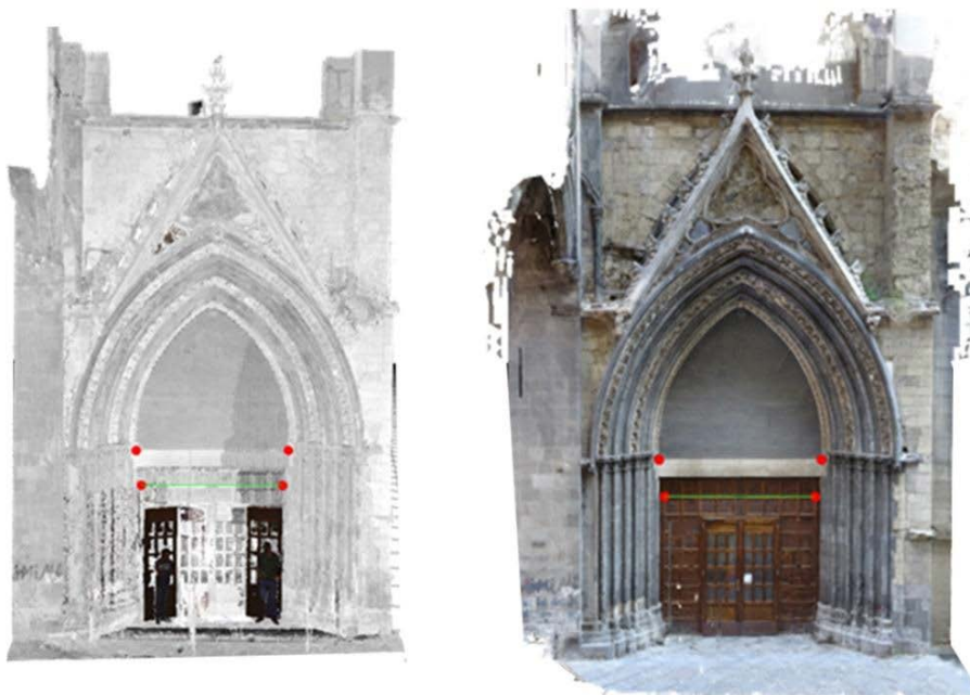
Figura 84: Nube TLS (sx), nube fotogramétrica (dx) y puntos de control (en rojo).
