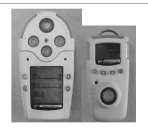
Figure VI.15: Gas Alert Micro: a) Multigas, b) monogas
