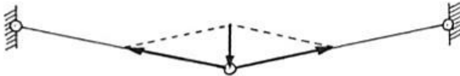
Fig. 2.18: Equilibrio del meccanismo infinitesimo sottoposto ad una azione esterna.
