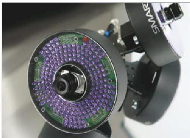
qualunque tipo di movimento con un elevato livello di precisione e accuratezza. Il sistema si basa su telecamere digitali che utilizzano sensori CCD a elevata sensibilità con illuminatori molto potenti.
