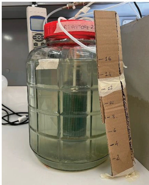
Figura 6-18 Reattore per il contenimento del refluo caseario
