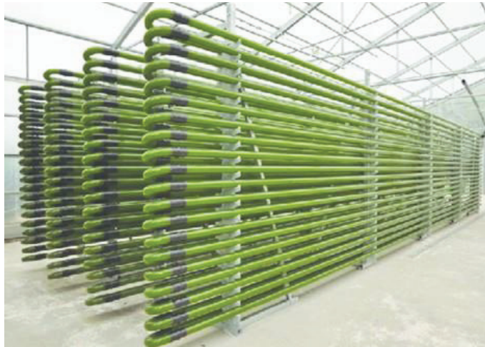
Figura 4-3 Sistema a tubolari orizzontali in serie e parallelo con diametro di 15 cm (Fonte: terraevita.edagricole.it )
