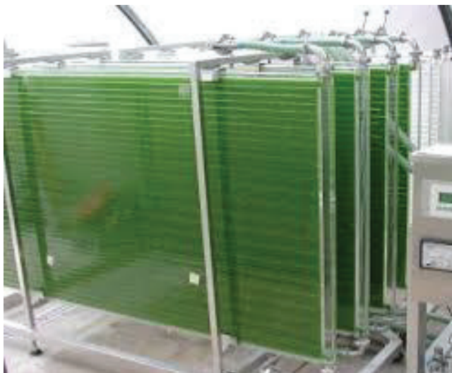
Figura 4-4 Sistema a pannelli costituito da lastre trasparenti in configurazione verticale (Fonte: webapi.ingenio-web.it )
