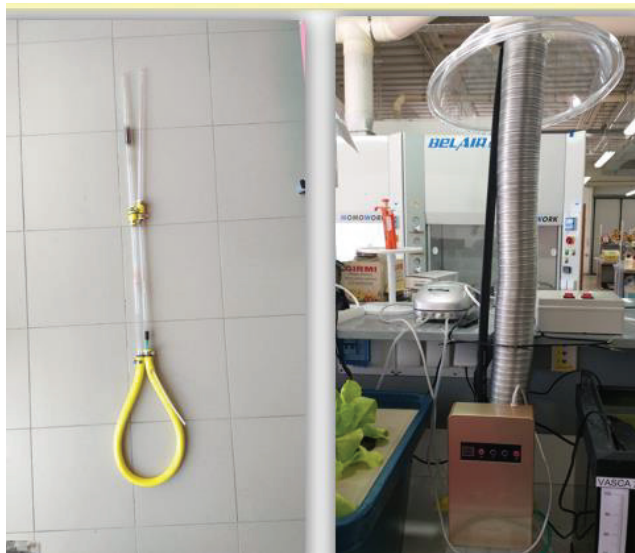
Figura 6-26 Tubo ad U per il trattamento ad ozono
