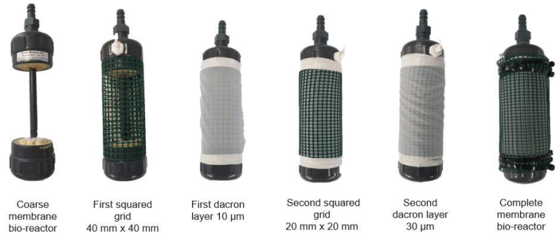
Figura 6-20 Layer della membrana dinamica autoformante
