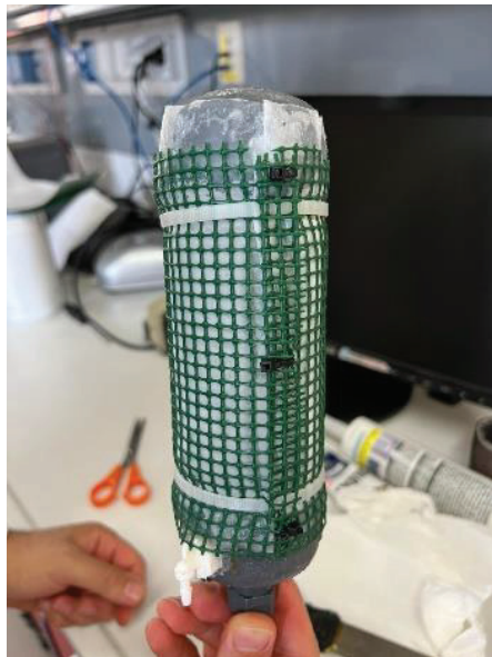
Figura 6-21 Membrana dinamica autoformante assemblata in laboratorio
