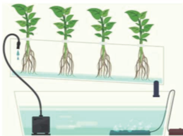
Figura 3-15 Dettaglio di uno schema di coltivazione NFT. (Fonte: Tecniche di coltivazione idroponiche– Aspetti progettuali e consumi idrici, 2015)
