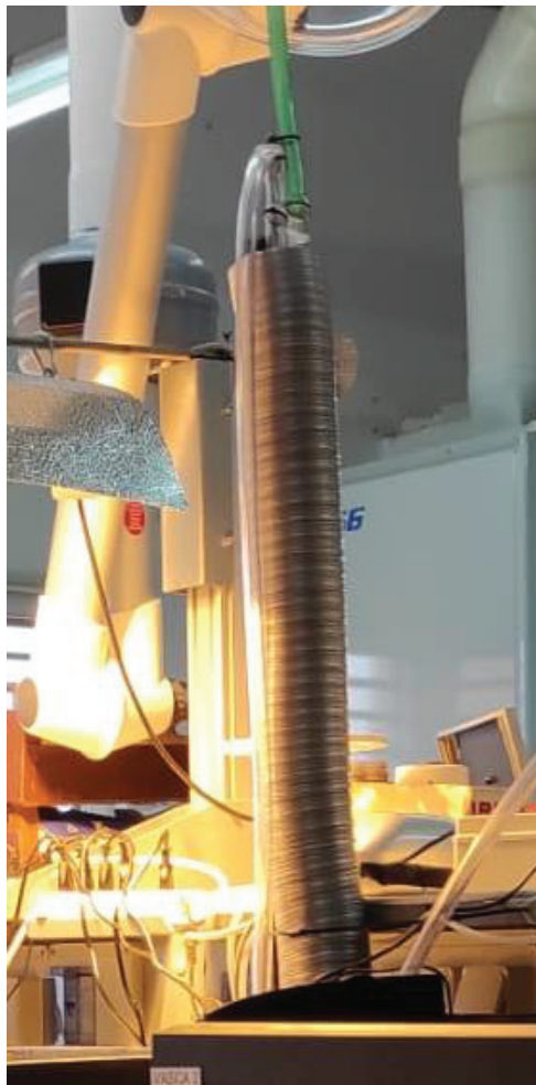
Figura 6-23 Cilindro metallico con alloggio luce UV
