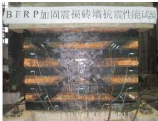
Fig. 2-50. BFRP retrofitting (Zhou et al 2013).
