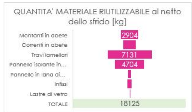
FIG. 53 INCIDENZA SUL TOTALE IN KG DEI VARI MATERIALI RIUTILIZZABILI AL NETTO DELLO SFRIDO DEL TERZO CASO STUDIO
