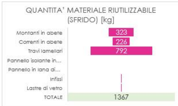
FIG. 52 INCIDENZA SUL TOTALE IN KG DEI VARI MATERIALI RIUTILIZZABILI DEL TERZO CASO STUDIO
