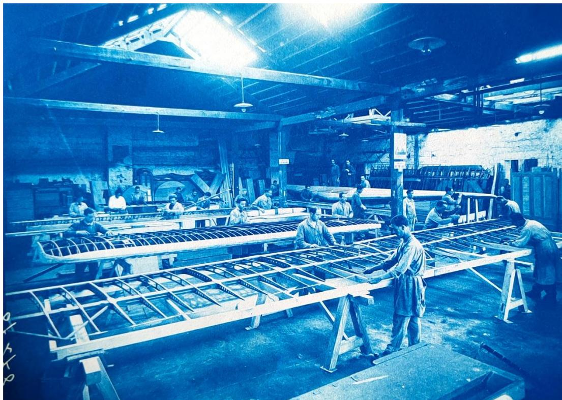
Fig.13 *Officine della Bacini e scali per la costruzione e riparazioni di parti per aeroplani*
