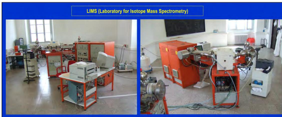
**Fig. 50** - Il TIMS in dotazione al *Laboratory of Isotopic Mass Spectrometry* (Foto di P.R. Trincherini).
