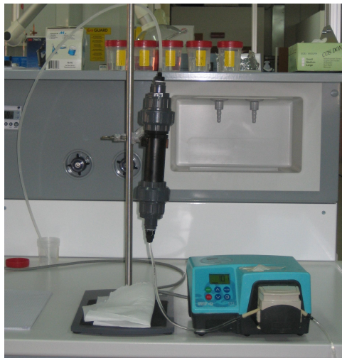
Figura 6.3 Apparato sperimentale per le prove di adsorbimento su soluzioni sintetiche
