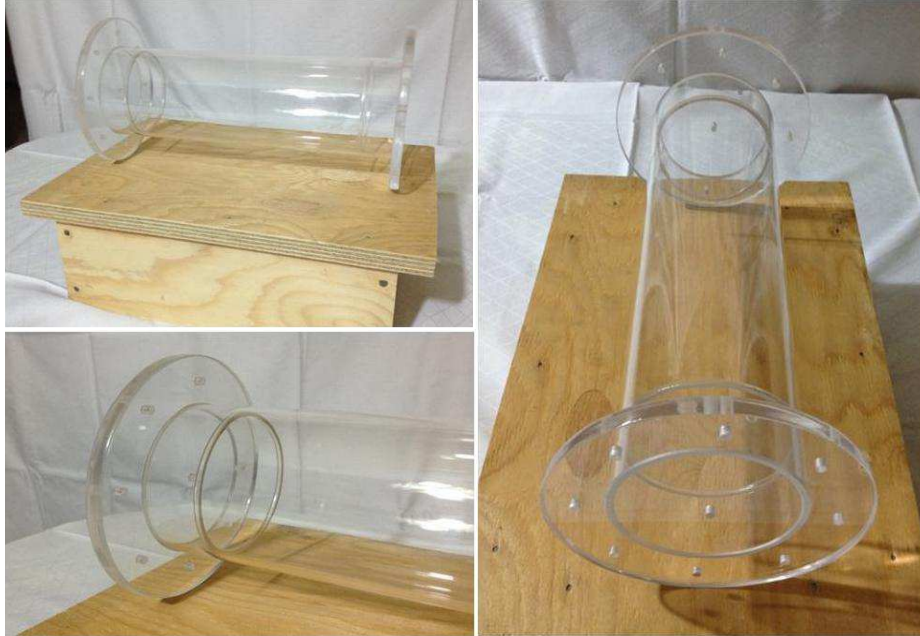
Figura 4.10 Reattore sperimentale in plexiglass per trattamenti EK
