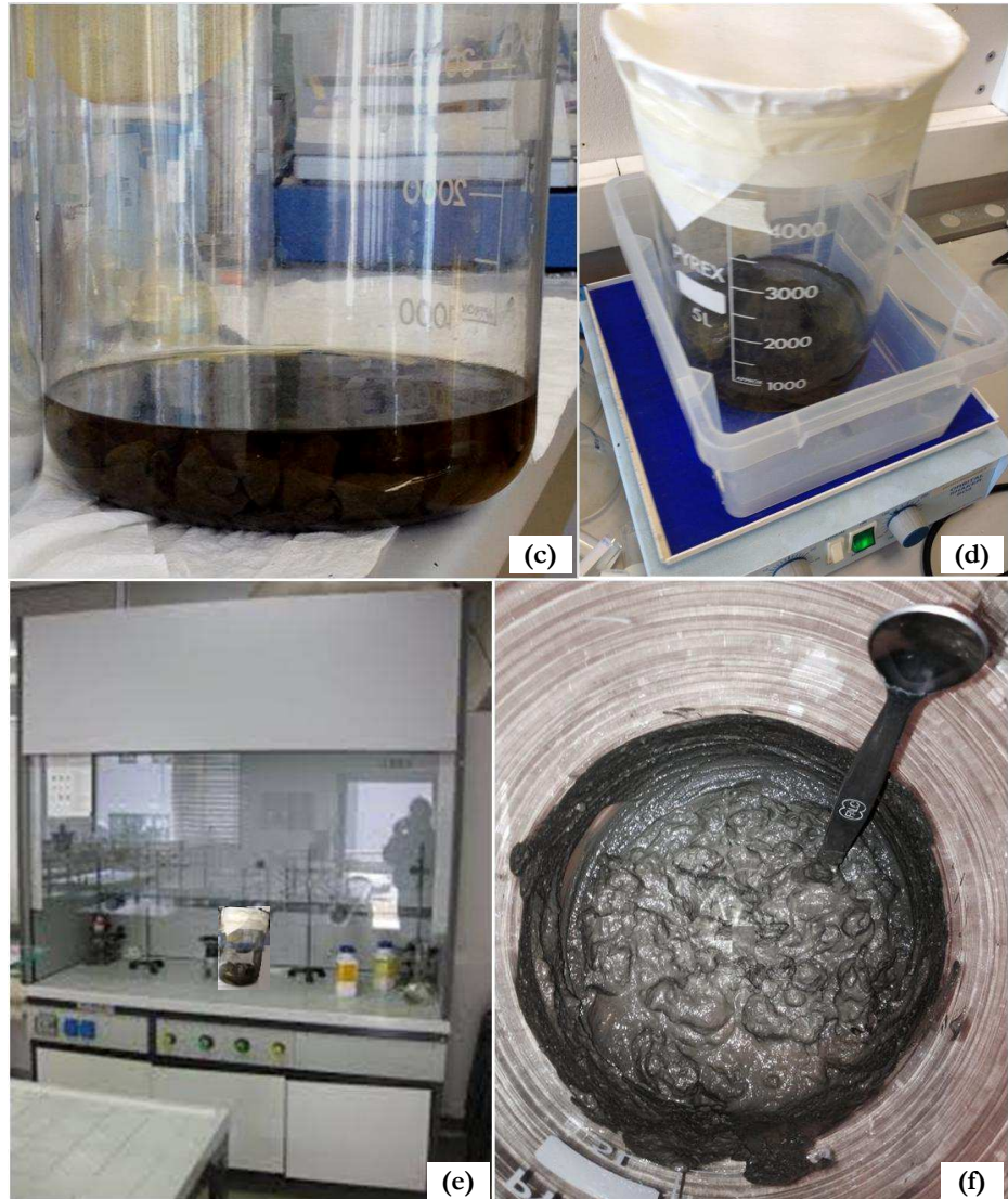
Figura 4.19 Contaminazione artificiale sedimenti: mescolamento con soluzione IPA (c), agitazione in schaker (d), essiccamento in cappa aspirante (e), idratazione e omogeneizzazione (f)
