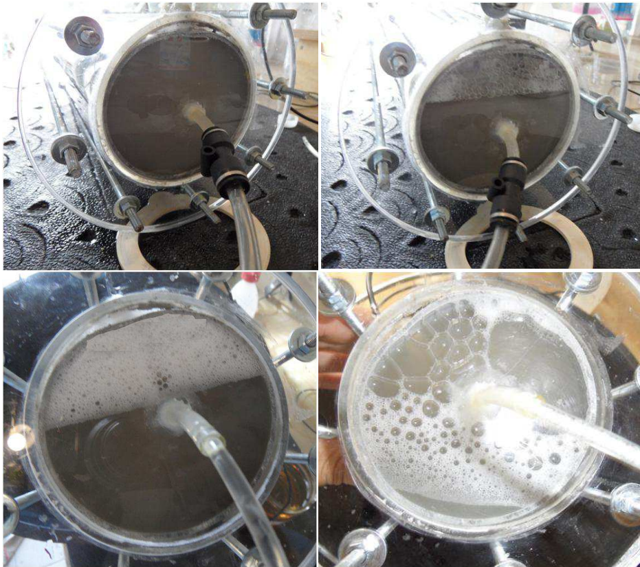
Figura 4.31 Evoluzione del progressivo intasamento del reattore durante i trattamenti
