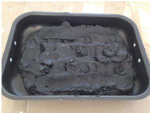
Figura 4.18 Contaminazione artificiale sedimenti: stesura in contenitore metallico
