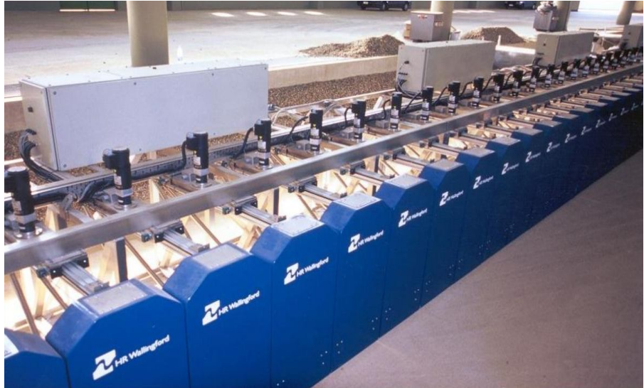
Figura 4.6 Il generatore di moto ondoso per i modelli tridimensionali
