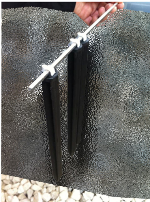
Figura 4.42 Picchetti in ABS per il posizionamento della sonda resistiva per la misura del runup (brevettato progetto)
