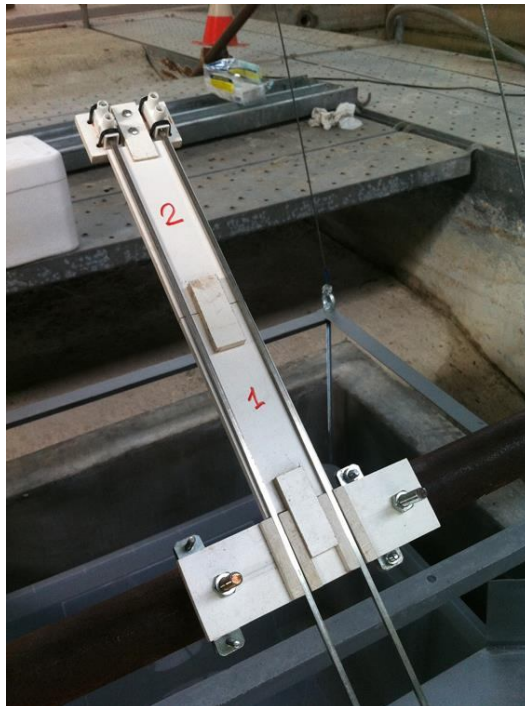
Figura 4.43 Sistema di ancoraggio e di scorrimento della sonda resistiva per la misura del runup. Sono visibili i due distanziatori per la taratura
