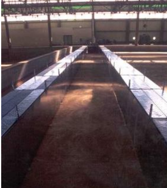
Figura 4.5 Vista parziale del canale per modelli bidimensionali del LIC
