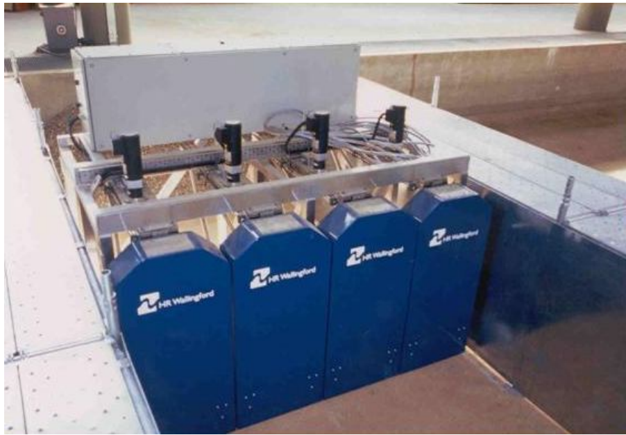
Figura 4.8 Il generatore di moto ondoso per i modelli bidimensionali del LIC
