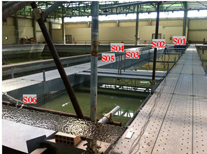
Figura 4.41 Immagine del canale con l'indicazione delle sonde resistive utilizzate (brevettato progetto)
