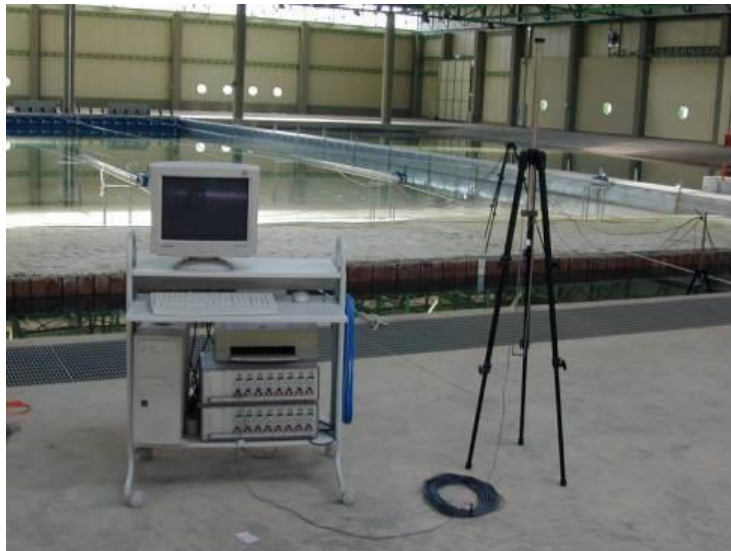
Figura 4.34 Sonda resistiva per il rilievo del pelo libero e sistema di acquisizione
