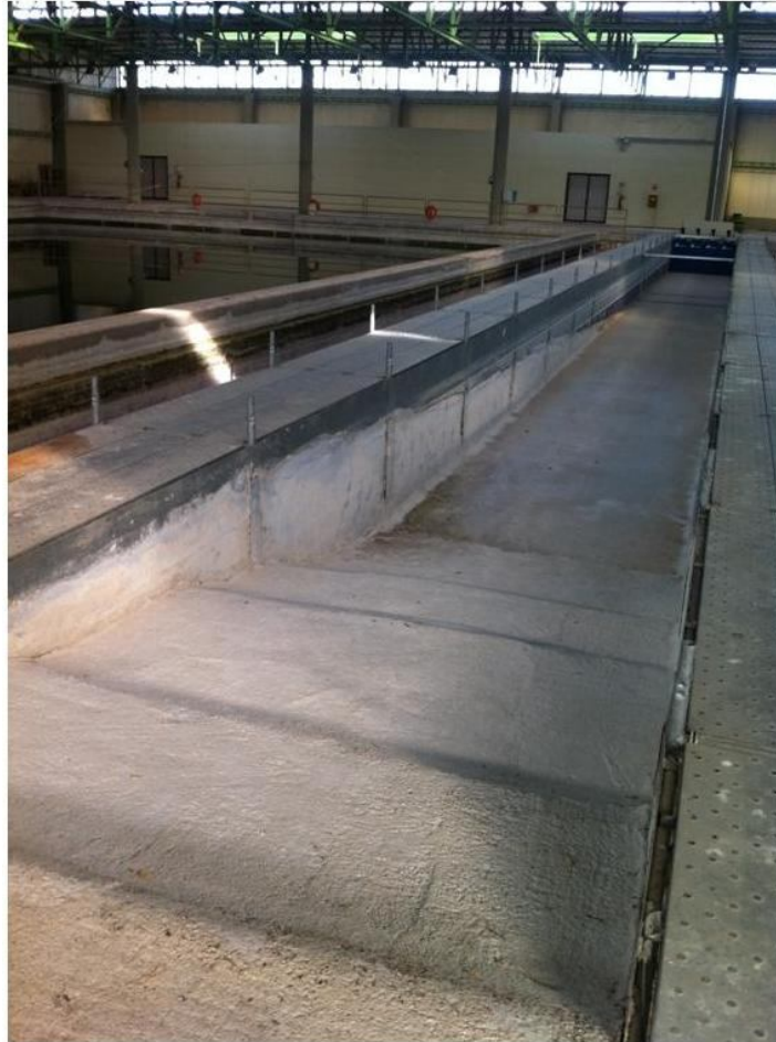
Figura 4.18 Il canale per i modelli fisici bidimensionali del LIC
