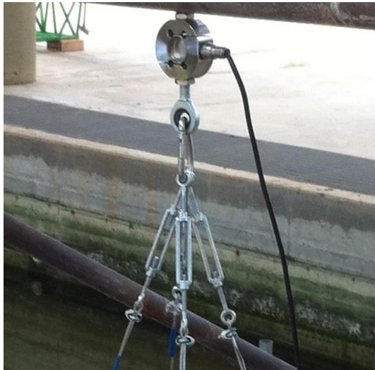
Figura 4.47 Particolare della cella di carico, della testa a snodo e dei tiranti
