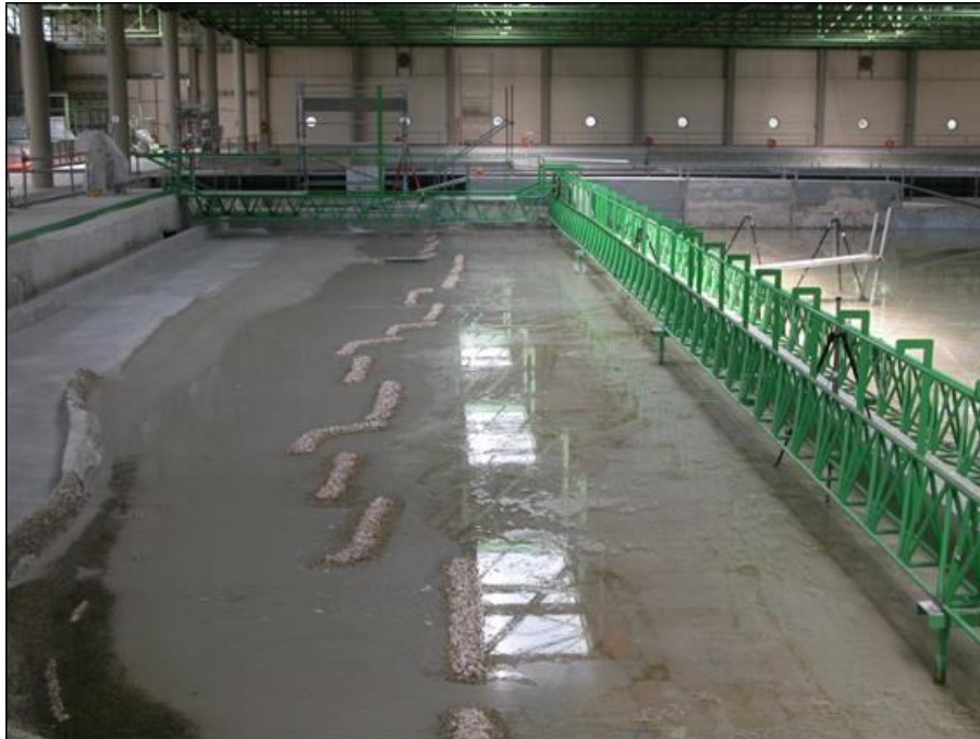
Figura 3.1 Un modello fisico 3D realizzato nel Laboratorio di Ricerca e Sperimentazione per la Difesa delle Coste (LIC) del Politecnico di Bari
