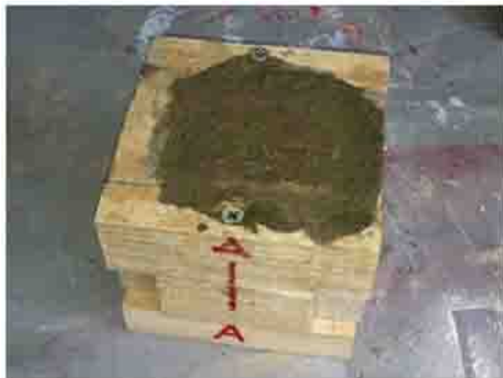
Figura 4.13 Una simulazione della realizzazione del masso: immediatamente dopo il getto (brevettato progetto)
