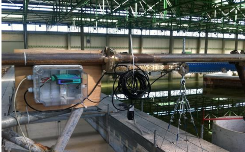
Figura 4.46 Sistema elettronico per la pesatura dei volumi di overtopping: sulla sinistra il convertitore A/D e sulla destra la cella di carico.
