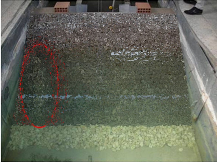
Figura 5.53 Erosione dello strato filtro messo a nudo dal dislocamento dei due massi di mantellata (brevettato progetto)
