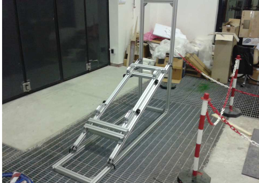
Figura 3.4 Telaio in alluminio appena realizzato, non ancora fissato al suolo.
