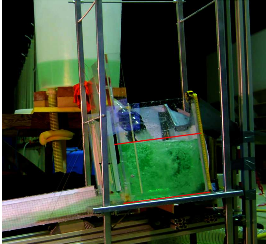
Figura 3.24 Fotogramma video con verifica dell'evoluzione temporale del tirante idrico nella vasca di carico
